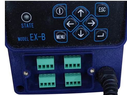
Terminales de conexiones para control remoto 4-20 mA
