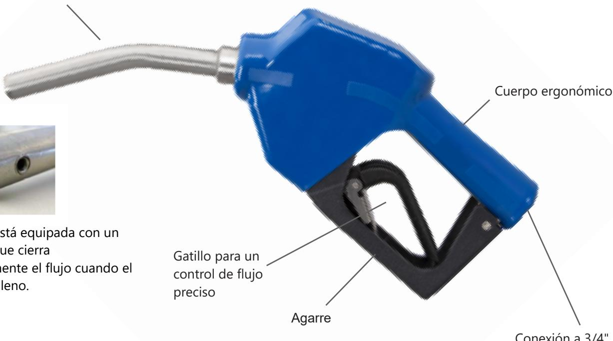
La palanca, fácil de operar, incluye una función de "bloqueo" que mantiene la palanca en la posición abierta, por lo que el operador no tiene que sostenerla manualmente. Incluso cuando la palanca está bloqueada en posición abierta, el flujo se detiene automáticamente cuando el tanque se llena, evitando derrames.
