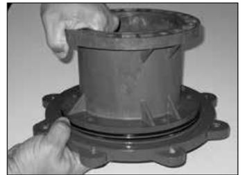
3. Inspeccione la junta tórica del adaptador del motor (elemento 12). Si está dañada, sustitúyala. Si es reutilizable, lubríquela con un lubricante químicamente compatible. Ver figura 37.
