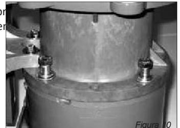
2. Agarre firmemente el motor y tire hacia atrás para desenganchar el motor y la bomba. Véase la figura 11.
