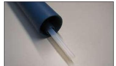
**4. Extracción del tubo interior y del soporte central** extraer el tubo interior y el soporte central, - Gire el tubo interior para soltar las juntas tóricas (elemento 11) y, a continuación, tire del tubo interior para separarlo del cabezal. Véase la figura 7 A y B.
