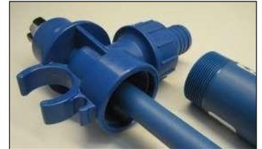
**5. Desmontaje del soporte central** - Si el soporte central de sustituirse, puede desmontarse abriendo los dedos y desenganchándolo de la cámara de aire. Para volver a montarlo, abra el soporte central de la misma manera que para desmontarlo y sobre la parte inferior de la cámara de aire. A continuación, deslícelo hacia arriba hasta que encaje en la ranura mecanizada. Asegúrese de que el cono apunta hacia abajo. Véase la figura 8 A, B y C.
