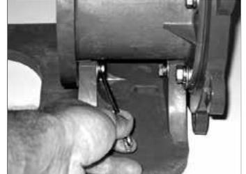
2. Retire los (5) pernos M8, arandelas de seguridad y arandelas planas (elementos 22, 23 y 24) del anillo de sujeción (elemento 11). Consulte la figura 35. Retire el anillo de sujeción del adaptador del motor. El anillo de fijación y el adaptador del motor encajan perfectamente debido a la junta tórica de protección contra el vapor (elemento 12). Separe con cuidado las dos piezas. Véase la figura 36.
