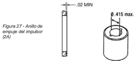
Figura 27 - Anillo de empuje del impulsor (2A)
