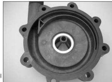
5. Desmonte el (elementos 4A, 4, 5, 5A). Inspeccione el impulsor y la transmisión en busca de signos de desgaste o daños. Busque signos de rozamiento o daños y desgaste en el impulsor y la transmisión . interna Véase la figura 15.
