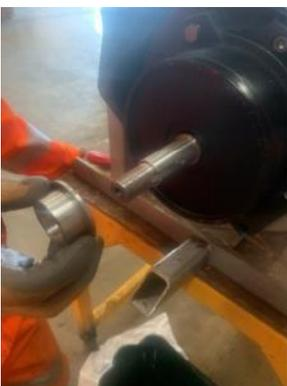
**13.** Retire las fijaciones que la cámara de aceite y saque con cuidado la cámara de aceite vacía. Es importante que esta parte permanezca perpendicular al eje, evitando el contacto con el propio eje. Esto se hace para evitar daños en la cara de desgaste del cierre mecánico estacionario inferior.
