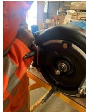
**31.** Inserte los espárragos mecanizados del colador.
