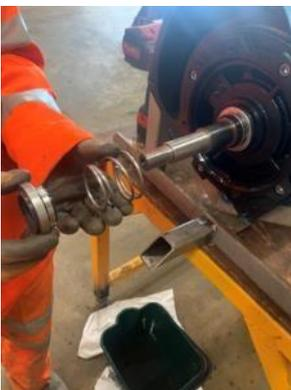
**17.** Retire la cara inferior giratoria del retén mecánico y retire el muelle del retén situado detrás de ésta. (izquierda)
