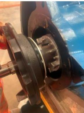
**21.** Retire las fijaciones de la placa de retención del cojinete inferior, que sujeta el cojinete o cojinetes inferiores en el alojamiento del cojinete.
