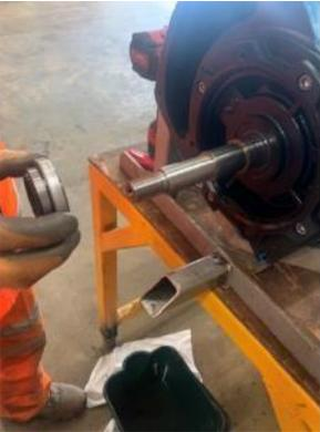
**19.** Afloje la placa de apoyo (tornillos de cabeza cilíndrica o tornillos prisioneros).
