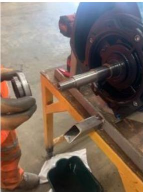
**18.** Coloque el muelle del cierre en el eje, seguido de la cara inferior giratoria del cierre mecánico.
