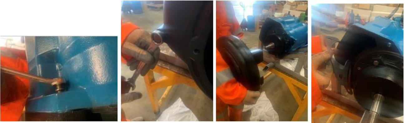
**11.** Asegúrese de retirar la junta de descarga inferior de la carcasa.
