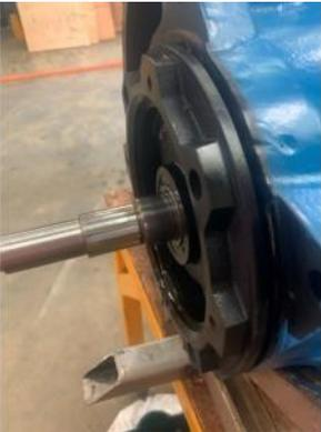
**20.** Retire con cuidado el rotor del estator, junto con el alojamiento del cojinete y los cojinetes superior e inferior.
