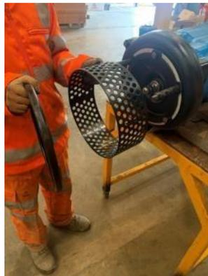
**6.** Retire los tres tornillos de fijación y los espárragos mecanizados del colador, liberando la placa de desgaste y los calzos correspondientes.
