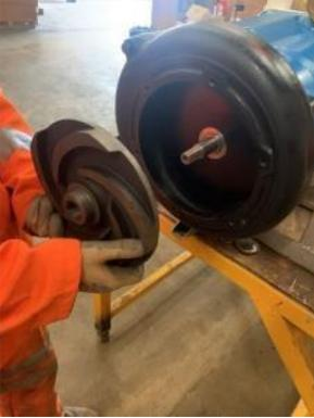
**29.** Inserte la tapa del impulsor, la arandela elástica, la tuerca de retención del impulsor y la tuerca de la tapa del eje.
