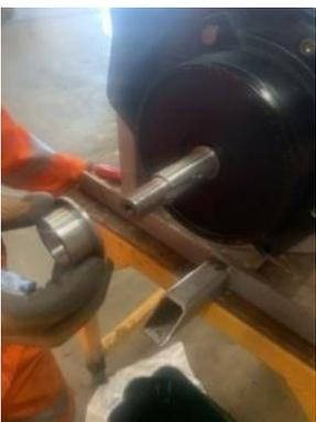
**25.** Coloque la junta de descarga inferior en el cuerpo de la bomba, utilizando grasa para mantenerla en su sitio si es necesario.
