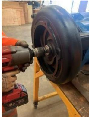
**30.** Coloque los calzos de la placa de desgaste en la placa de desgaste y colóquela en la voluta, fijándola con tres tornillos de fijación (utilizando uno de cada dos orificios roscados).
