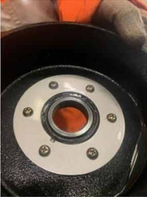
**21.** Coloque la junta tórica de la cámara de aceite en la cámara de aceite.
