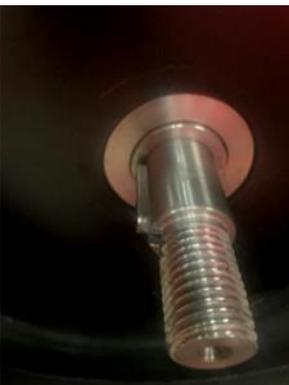
**28.** Empuje el impulsor sobre el eje con antiadherente, no utilice calor.
