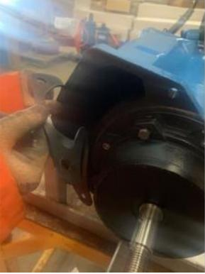
**26.** Fije la voluta a la carcasa de la bomba principal con tornillos de fijación.
