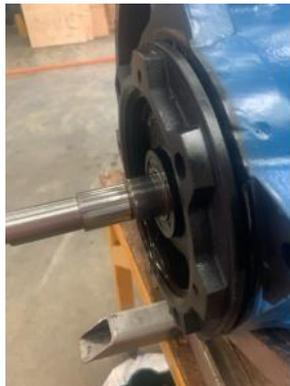
**16.** Fije el cojinete en su sitio con tornillos de cabeza cilíndrica o tornillos prisioneros (según el modelo de bomba).
