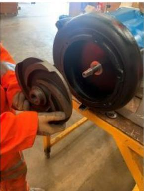
**9.** Retire la chaveta del impulsor del chavetero del eje.
