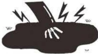
Para evitar que entre agua en el interior del , asegúrese de moldear firmemente la conexión del cable presionado
